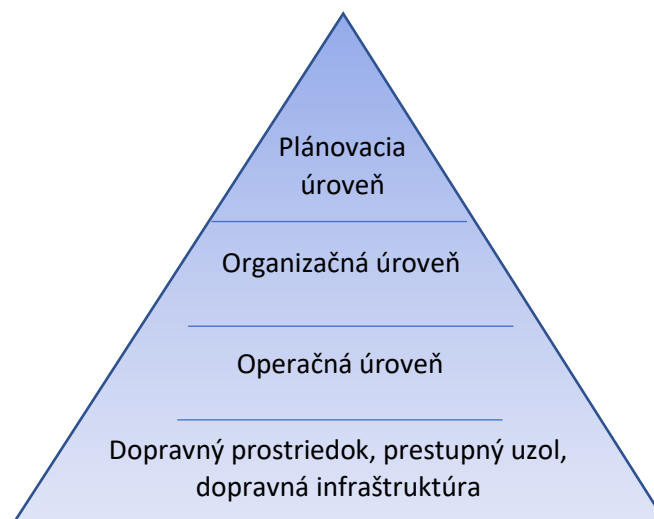
Obrázok 38 Controlling verejnej dopravy– základná architektúra telematiky vo verejnej doprave
